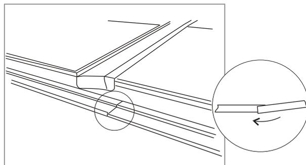
Die Seitenbleche werden mittels Befestigungsklammern und Breitkopfnägeln befestigt. (siehe Bild)
