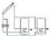
2-Speicher-Solarsystem mit Pumpenlogik
