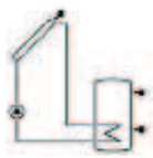
Standard-Solarsystem: 1 Kollektor, 1 Speicher
