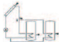
2-Speicher-Solarsystem mit Ventillogik
