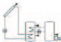
Solarsystem mit Nachheizung durch Feststoffkessel
