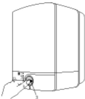
Durch Drücken des Zusatzknopfes (3) heizt das Gerät den Wasserinhalt einmalig auf 90°C auf. Die rote Kontrollleuchte blinkt bis die Temperatur erreicht ist. Danach regelt sich die Temperatur wieder auf den vorher eingestellten Wert ein. Soll der zusätzliche Aufheizvorgang vorzeitig gestoppt werden, Knopf ein zweites Mal drücken während die rote Leuchte blinkt.
