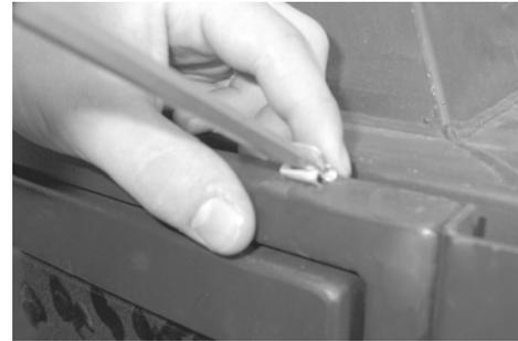
**Abbildung: 2 Montage Clip A am Einsatz**
