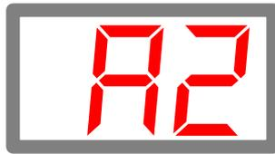
Unter dem Menüpunkt A2 legen Sie die Temperaturdifferenz zwischen Fühler 1 / T1 und Fühler 2 / T2 fest.
