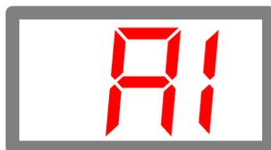
Unter dem Menüpunkt A1 können Sie zwischen EIN und AUS wählen. Dies ermöglicht Ihnen den Test des installierten Gerätes. Auch der permanente Betrieb des Gerätes kann mit dieser Funktion geregelt werden.
