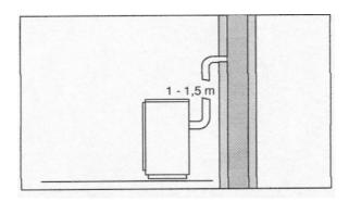
Vermeiden Sie längere und besonders waagerechte Abgasrohrführungen. Das Abgas kann zu stark abkühlen, außerdem wird der wirksame Förderdruck verringert. Isolieren Sie Abgasrohre, die durch kalte Räume geführt werden mit wärmebeständigem Material. Alle Anschlussstellen müssen fest sitzen und sind mit feuerbeständigem Dichtband, bzw. anderen geeigneten Materialien, abzudichten.
