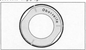
• Das Umlenkblech in der Brennkammer muss vor dem Abgasstutzen fest eingehängt sein.
