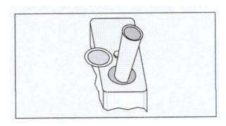
Die Ölstandsanzeige kann herausgenommen und in heißem Wasser mit Spülmittelzusatz ausgewaschen werden. Danach unbedingt gut trocknen und erst dann wieder in den Tank einsetzen.
