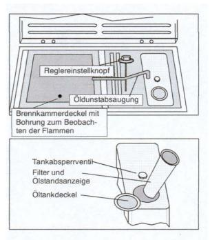
Die Öldunstabsaugung (nicht alle Modelle) Zwischen Tank und Brenner führt Öldunst aus dem Tank in die Brennkammer ab. So entsteht beim Öffnen des Tanks keine Geruchsbelästigung.
