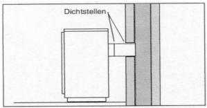
Längere Abgasrohre dürfen nie waagerecht, sondern nur mit Steigung zum Schornstein, montiert werden. Der Rohrquerschnitt darf nicht verringert werden. Der Förderdruck soll je nach Leistung des Gerätes mindestens 0,1 mbar bzw. 0,15 mbar (1,0 - 1,5 mm WS) betragen (s. Tabelle Seite 3).
