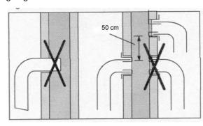
Das Abgasrohr muss mit einem Wandfutter so in den Schornstein eingeführt werden, dass es nicht in den freien Querschnitt hineinragt. Bei Anschluss eines weiteren Ofens an den gleichen Schornstein muss eine vertikale Differenz von mindestens 50 cm zwischen den beiden Anschlüssen eingehalten werden.
